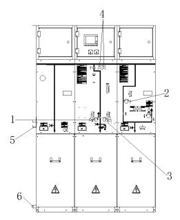
Figure 2-12 Ring main unit DQS-40.5 DVC appearance
