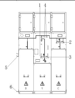
Figure 2-11 Ring main unit DQS-24 DVC appearance
